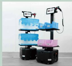
ラピユタAMRは独自の群制御AIを用いて、既存の倉庫レイアウトを変えることなく作業効率を上げることが可能です。大手物流会社で現場稼働しています。
